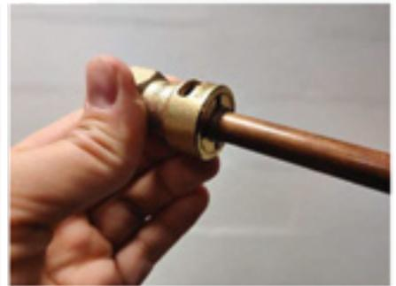
Utilisez le calibre pour marquer le cuivre (contrôle profondeur).
